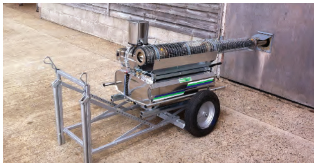
Abbildung 4. Heißnebelgerät (Bildrechte: Agrex Limited)
